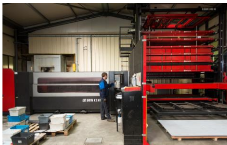
Laser Amada 4000W Format 1500 x 3000 Chargeur automatique 9T
