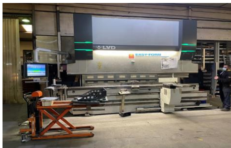
3 Presses plieuses avec correction d'angle, capacité 4m + presses à emboutir
